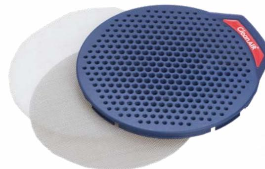
El parachispas evita que el filtro se dañe por la acción de las chispas calientes y las salpicaduras, mientras que el pre-filtro intercepta las partículas gruesas prolongando la vida útil del filtro. Con el parachispas se reduce significativamente el coste de mantenimiento del filtro.
