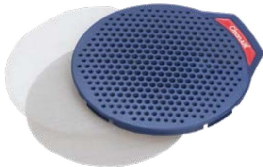
Der Funkenfänger verhindert, dass der Filter durch heiße Funken und Spritzer beschädigt wird. Der Vorfilter filtert die groben Partikel und verlängert die Lebensdauer des Hauptfilters. Die Verwendung des Funkenfängers reduziert die Wartungskosten.
