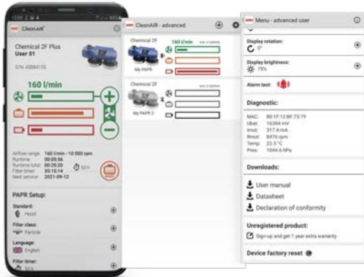
Alle Einstellungen für Ihr CleanAIR®-Gerät an einem Ort, leicht zugänglich über Bluetooth. Dadurch erhalten Sie ein großartiges Tool zum Verwalten von Einstellungen wie Kopfteil, Filtertyp, Filtertimer und vielem mehr. Benutzerhandbuch und Konformitätserklärung sind auch direkt über die App zugänglich. Im erweiterten Benutzermodus können Sie mehr als ein Gerät gleichzeitig verbinden, wodurch Sie nahezu in Echtzeit einen perfekten Überblick über Ihre PAPR-Flotte erhalten.
